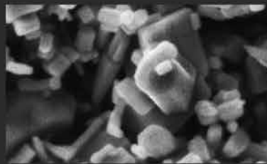
試料:酸化亜鉛 加速電圧:5 kV、倍率:50,000倍 / 信号:二次電子像、導電処理なし
