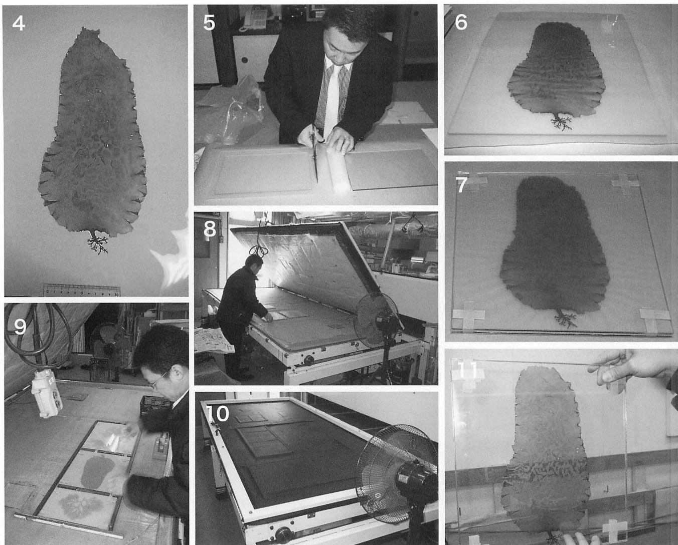
図4-10 木村染匠株式会社御室工房における海藻（褐藻アントクメ）のガラスサンド標本の製作過程の実際。 4. あらかじめ透明なフィルム上で圧されたアントクメの押し葉標本。 5. 表面をよく拭いたガラス板（水分や油が剥離の原因となる）の上にやや大きめの樹脂フィルムを載せる。 6. 樹脂フィルムの上にアントクメの押し葉を載せる。 7. さらに樹脂フィルムを被せ、ガラス板を載せる。はみ出た樹脂フィルムを切り落としてから4つの角をテープで固定する。 8. 簡易合わせ硝子装置。 9. 高圧による横ずれを防ぐため、木枠で固定する。 10. 一定時間2 tの圧力をかけた後、扇風機で風を送ってゆっくり冷やす。急速な温度変化はひび割れを招く。 11. 完成品。樹脂フィルムは熱で溶解して透明になる。
